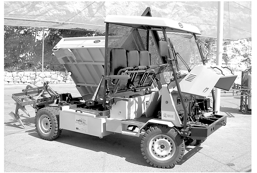
Le véhicule multifonctionnel qui roule à l'énergie solaire peut semer, défricher, arroser ou encore être utilisé pour l'épandage d'insecticides ou comme transporteur de marchandises.
